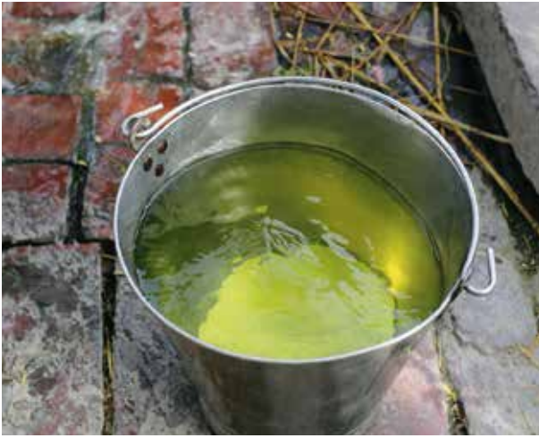
Das gelbliche Wasser aus einem Brunnen in der Nähe einer COPR-Deponie ist stark Cr(VI)-verseucht
